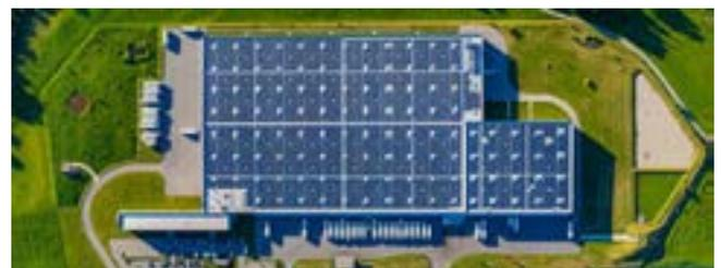
**Abb. 6:** Das perfekt integrierte Solardach des Logistikzentrums in Perlen/LU mit der 6.4 MW PV-Anlage produziert mit jährlich **7.33 GWh** mehr als doppelt so viel wie es benötigt; und mehr als 4 Kleinwasserkraftwerke (KWKW). Mit dem Solarstromüberschuss können 3'000 E-Autos jährlich 12'000 km CO<sub>2</sub>-frei fahren, mit dem gesamten Solarstrom sogar **5'200 E-Autos**. Dies entspricht der **PW-Flotte einer Kleinstadt**.
