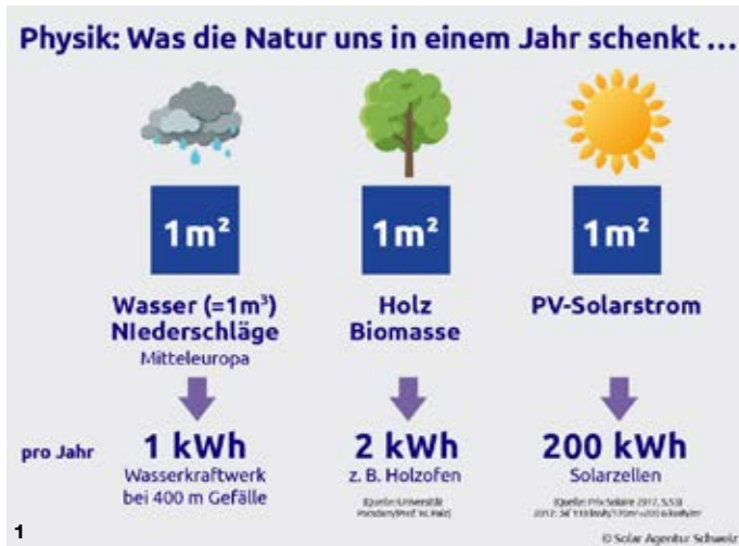
Abb. 1: Energieertrag pro Jahr: Die Abb. 1 zeigt den physikalisch gemessenen Energieertrag pro m 2 während 8760 h des Jahres im Vergleich: Die Niederschläge in Mitteleuropa garantieren ca. 1 m hohe Wassersäule, d. h. 1 m 3 /a oder 1 t Wasser kann bei 400m Fallhöhe rund 1 kWh/a Hydroenergie generieren; Biomasse etwa 2 kWh/a. Wasser kann aber bis 200 Mal zum Pumpen verwendet werden. Umgekehrt bei der Solarenergie: Die PEB-Stromüberschüsse betragen jährlich bis 200 kWh/m 2 ; die Sonne scheint aber nur während ca. 2'000 Stunden. Die übrige Zeit – fast über 6'000 h – ist sie auf Regellenergie angewiesen. Bei optimaler Koordination generieren PEB und PSKW zusammen genug Regellenergie übers ganze Jahr, um mindestens 100% Stromsicherheit zu garantieren - ohne die gefährdete Biodiversität oder einen Bach zu zerstören.
