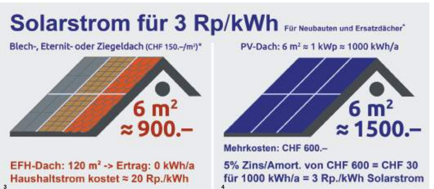
Abb. 3 und 4: Solarstrom für 3 Rp./kWh und Rechtsgleichbehandlung: In fünf Kantonen wurden 2018 Offerten für 1 m 2 Blech-, Eternit- und Ziegeldach für etwa 100 m 2 ausgewertet. Im Durchschnitt kostet ein traditionelles Dach rund 150 Fr. m 2 . 6 m 2 kosten somit (6×150 Fr.) ≈ 900 Fr. Eine PV-Anlage von 6 m 2 kostet (ab 5 kW) ca. 250 Fr./ m 2 inkl. Wechselrichter etc. Ergibt somit ≈ 1'500 Fr. bzw. 600 Fr. teurer als 6 m 2 Blech-/Eternit-/Ziegeldach. 6 m 2 PV ≈ 1 kW generiert ≈ 1'000 kWh/a für 600 Fr. Mehrkosten. Zu 5% Zins inkl. Amortisation von 600 Fr. resultieren ≈ 30 Fr. für 1'000 kWh/a, d.h. Solarstrom ≈ 3 Rp./kWh für Neubauten und Ersatzdächer (Inzwischen Offerten unter 1'000 Fr./kW). «Ungerechtfertigte technische Handelshemmnisse» sind ge-
