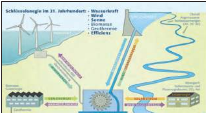
Abb. Regelenenergie für Mitteleuropa - PEB-PSKW-Modell: Tagsüber Solarstromüberschüsse und im Winterhalbjahr die hohen deutschen Windstromüberschüsse hochpumpen, um Regelenenergie für die Nacht, bei Windstille und an sonnenarmen Tagen zu produzieren (vgl. Schweiz. Greina-Stiftung [SGS], Geschäftsbericht 2007 bis 2018). Ökonomisch interessant und konkurrenzfähig ist die Windenergieerzeugung bei durchschnittlichen Windgeschwindigkeiten von mindestens 6 m/s. Solche Voraussetzungen existieren vor allem im Winterhalbjahr in Nord-Deutschland.
