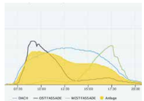
4 Ost-West-Fassaden- und Dachtrag im Tagesverlauf des MFH Culmannstr. 53 ab 7 Uhr 30 bis 20 Uhr, 18.06.2017 (Schweiz.Solarpreis 2016, S. 70.)
