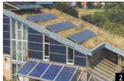
2: Die nicht integrierte PV-Anlage "erntet" bis 70% weniger Strom vom Dach im Vergleich zu Abbildung 1.
